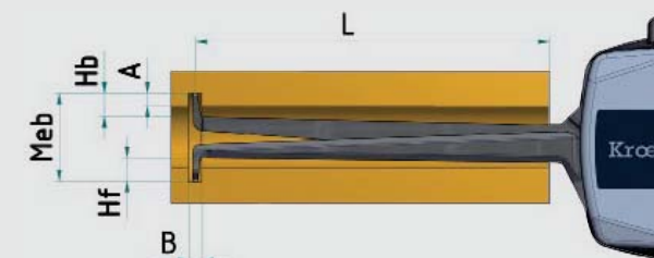
Meb Rozsah měření A Hloubka drážky B Šířka drážky Hb Hloubka měření Hf Měř.kont.poh. L Měř.kont.pev.
